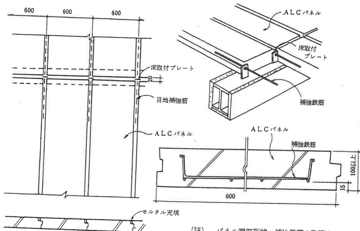
(註) パネル端部形状、補強鉄筋の配筋法およびパネル取付ディテールは一例を示す。
