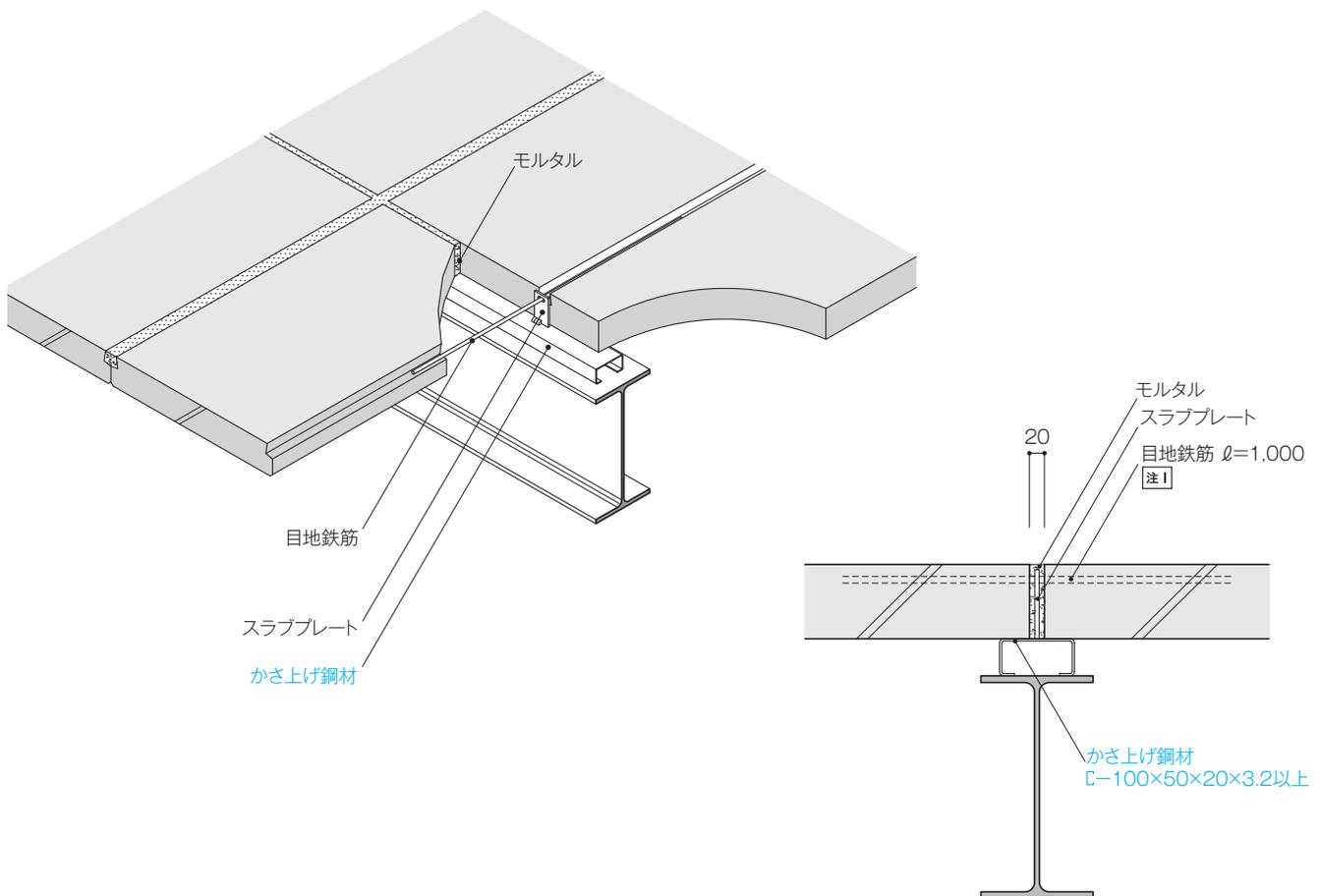
注1 目地鉄筋：目地鉄筋は9φまたはD10とする。
