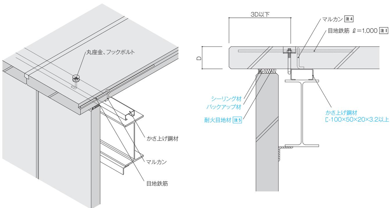
※軒部のようにパネル下面からの吹き上げ荷重が作用する場合は、丸座金とフックボルトを併用するなどの対策が必要な場合があります。
