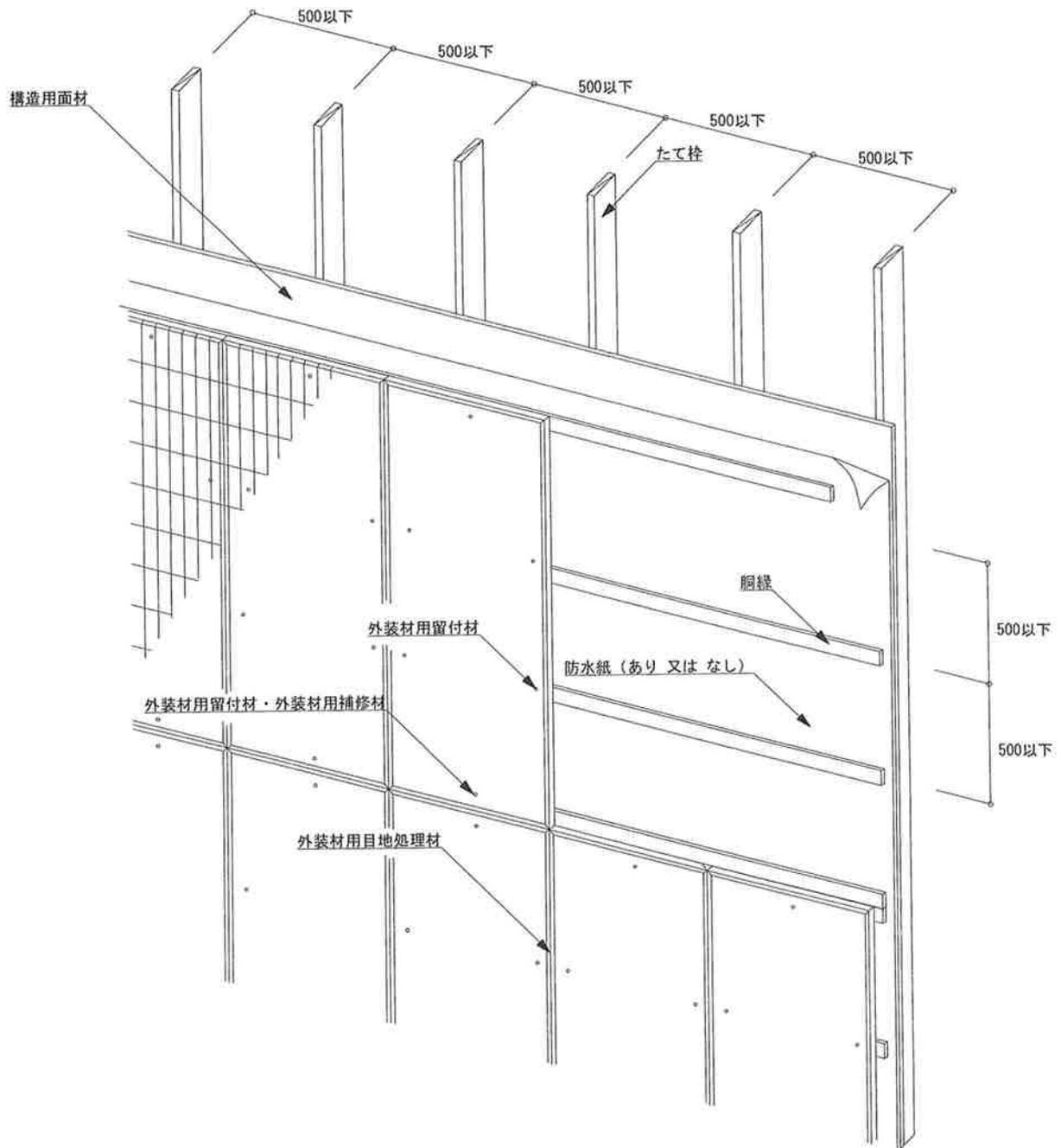
図1 構造説明図 (透視図・断熱材なし)
