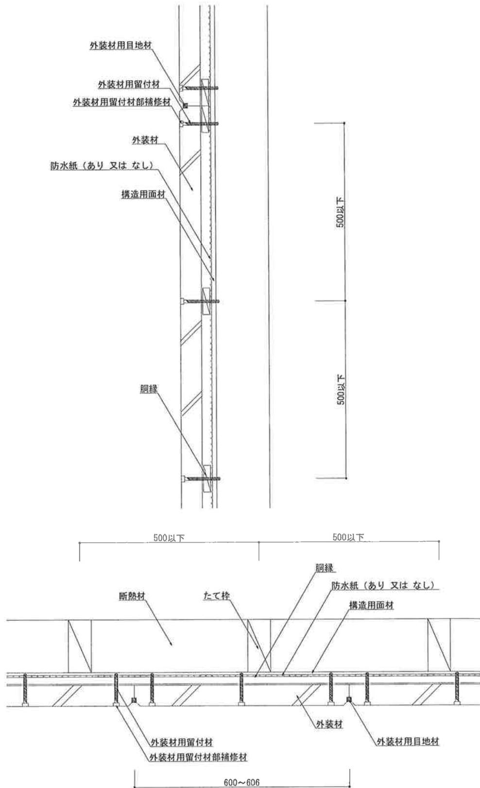
図2 構造説明図 (水平垂直断面詳細図・断熱材なし)
