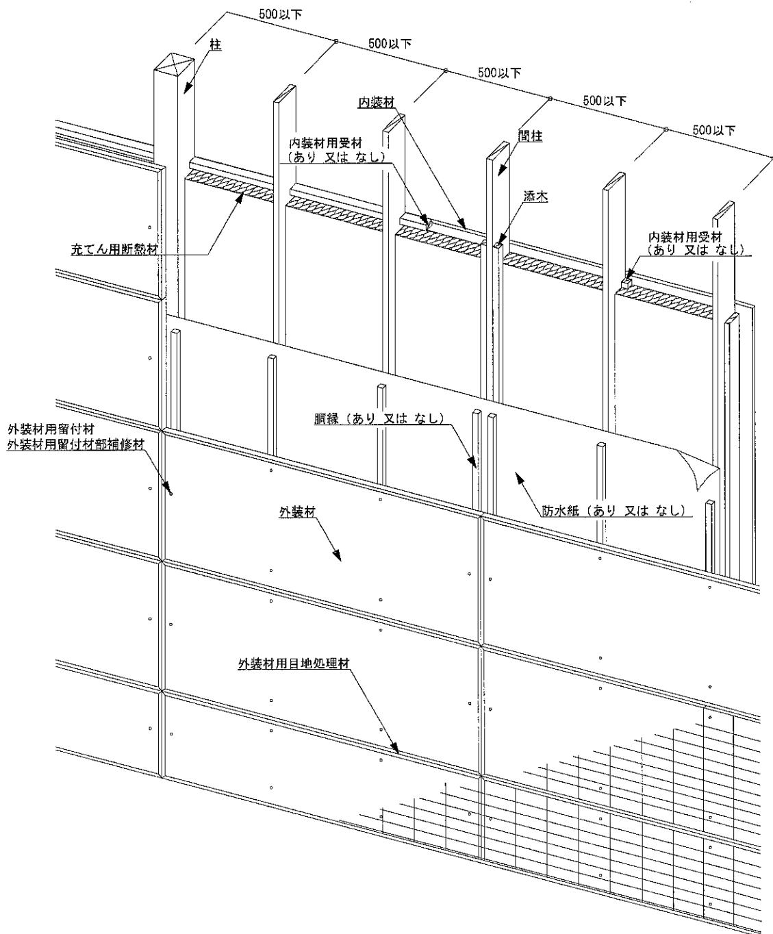
図1 構造説明図（透視図・構造用面材なし／内装材（单張）／充てん用断熱材あり）
