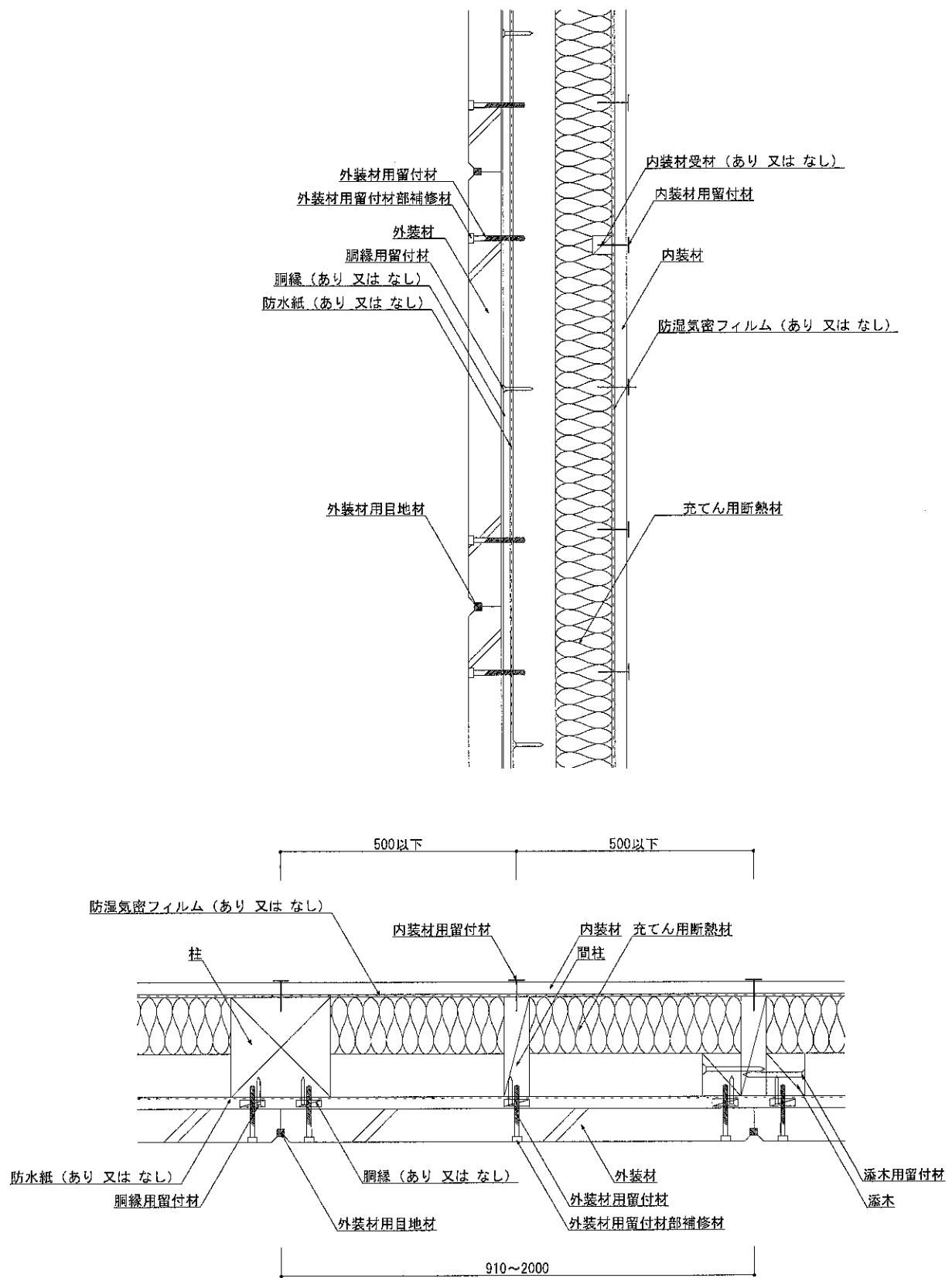
図2 構造説明図（断面図・構造用面材なし／内装材（单張）／充てん用断熱材あり）
