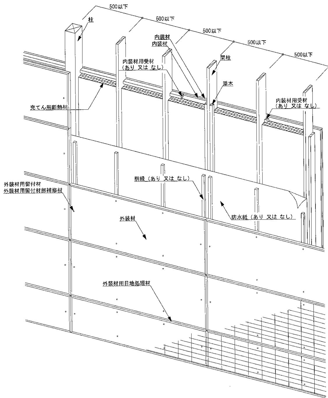
図1 構造説明図（透視図・構造用面材なし／内装材（重張）／充てん用断熱材あり）
