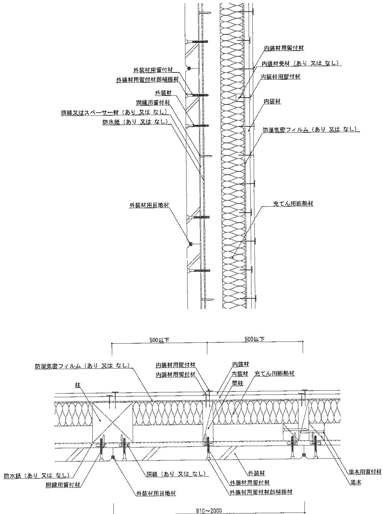
図2 構造説明図（断面図・構造用面材なし／内装材（重張）／充てん用断熱材あり）
